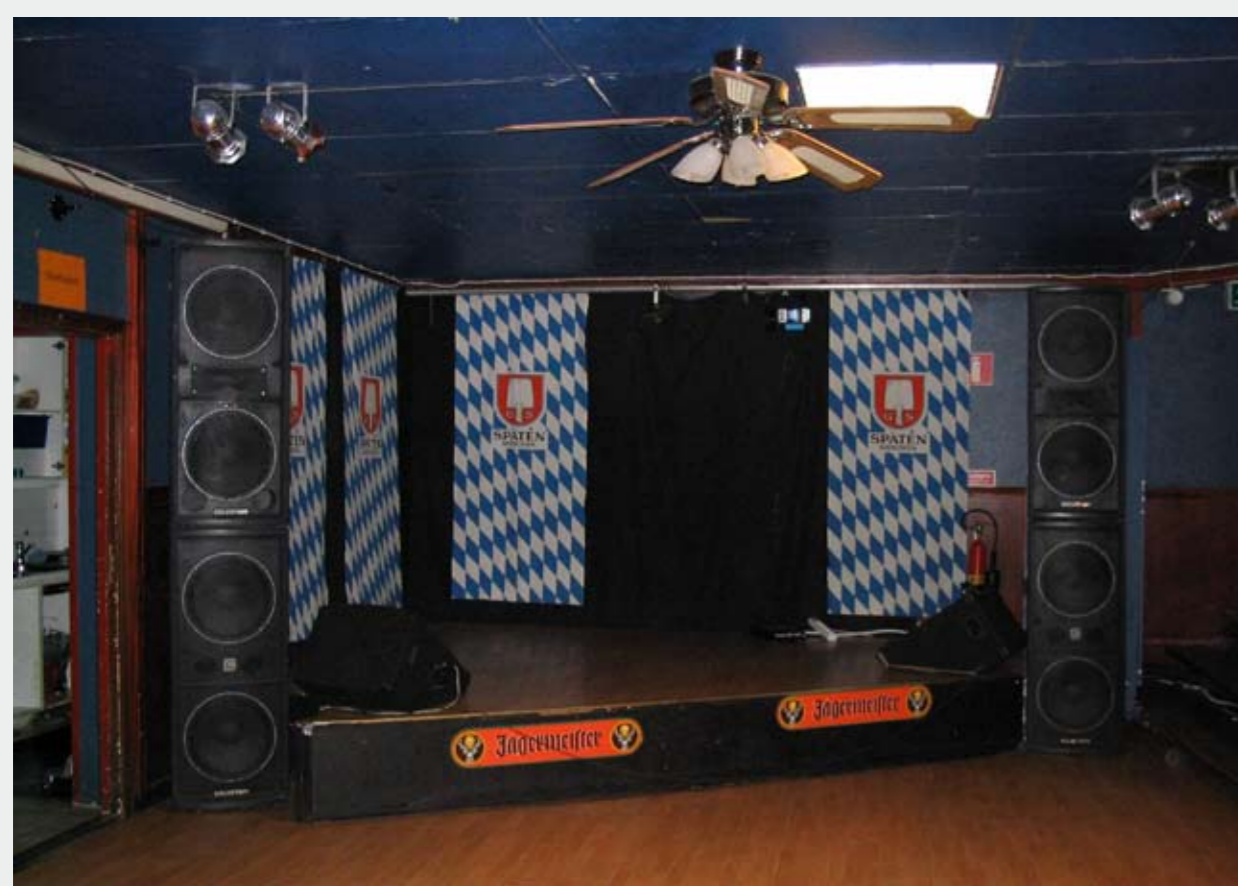
Scenen på Henriksbergs takterrass före ombyggnaden. Scenen är mycket liten och publiken hamnar mycket nära scenutrustningen och PA-högtalarna. Endast tunna textilier på scenväggarna och övermalade absorberer i taket.
