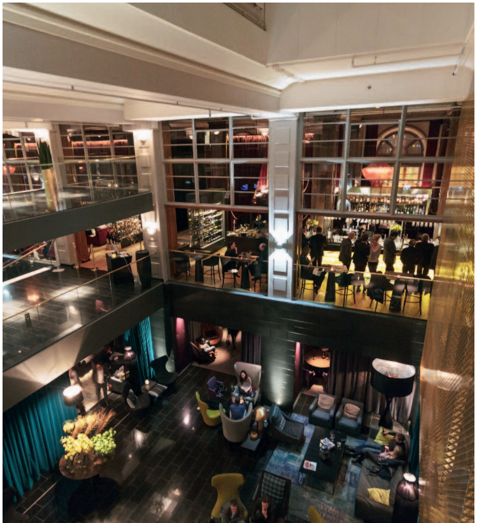
Den stora foajé och lobbyhallen, där man i underkant har "living room" med tunga textilier, bakom den glasade väggen ser vi Kassahallen, och till vänster bryggor vid hissarna. Bakom det guldkimrande gallret till höger finns svarta mineralullsabsorbenter, i lanterninerna längst upp är mineralullsabsorbenter limmade, absorbenter sitter även på bryggornas undersida. På sidan av hisstornet finns perforerade gipsskivor.
