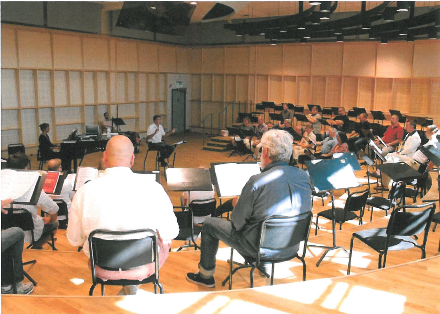
Rymd, ljus, akustik – den nya korsalen har allt en professionell operakör i världsklass kan önska sig. I taket syns den konformade reflektorn och en reflektor i plexiglas, utformade för att få bra medhörning. Foto: Alf Berntson.
