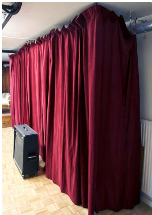
🔺 Tjockt tyg som fungerar som absorberent. Avståndet från väggen ut till tygets framsida är väl mätt för att absorbera givna problemfrekvenser. Tyget fungerar också som drapperi för avlastningshyllor bakom. Smart!
